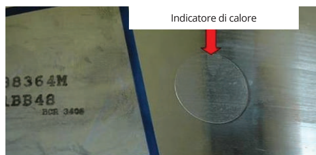
Immagine 13-3 Indicatore di calore sul canale della ruota
