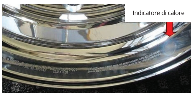
Immagine 13-2 Indicatore di calore sulla flangia della ruota
