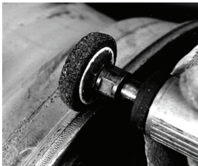
Immagine 13-32 Smerigliatrice pneumatica o elettrica Si tratta di un altro metodo veloce ed efficace per rimuovere i bordi taglienti creatisi per l'usura delle flange del cerchio. Fare attenzione in quanto le mole potrebbero "diventare pastose" a causa dell'alluminio asportato. Evitare di scalfire la ruota.
